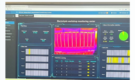
▲ 中色卢安夏电积槽面在线智能监测系统
